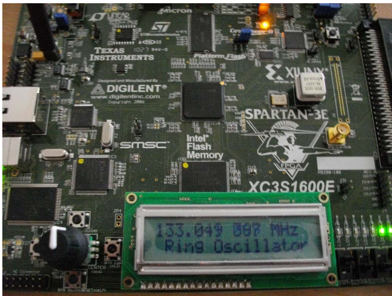
Obrázek 5: Funkční vzorek modulu modulu FC_CORE na desce S3E1600
